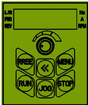
Встроенный в модуль управления CU0B пульт может использоваться для установки/считывания параметров, управления, мониторинга и т. д.
